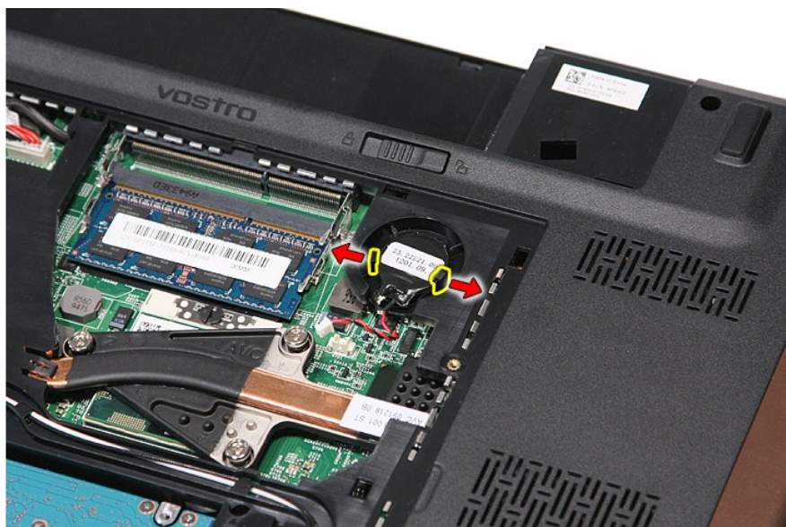
6. הרם את סוללת המטבע והסר אותה מהמחשב.
