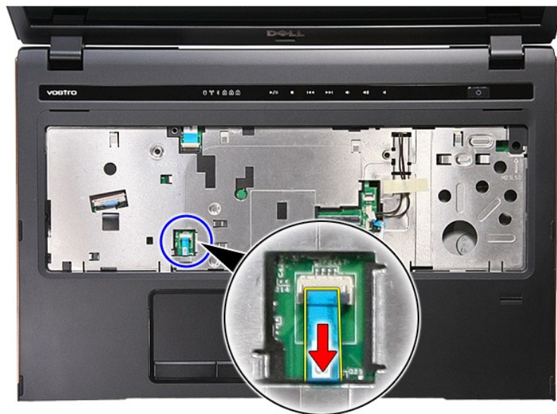
17. פתח את התפס המצמיד את כבל הנתונים של לחצן המדיה אל המחבר שלו בלוח המערכת.
