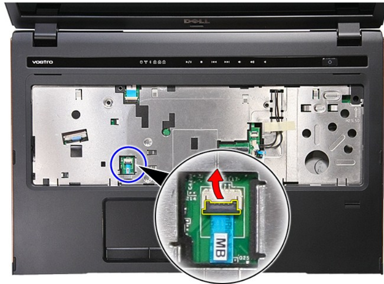
16. נתק את כבל הנתונים של לוח המגע מהמחבר שלו בלוח המערכת.
